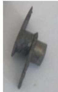
Рис.1. Структурная схема и внешний вид слоистого ТЭ: 1 и 2 – ветви p- и n-типа, 3 – коммутационные пластины
